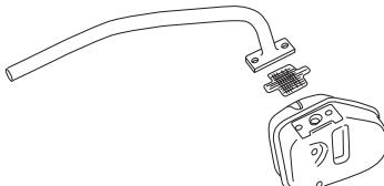
Если на вашем инструменте стоит глушитель такого типа, то сетку следует очищать не реже одного раза в неделю. На глушителях с катализатором, такую очистку достаточно производить раз в месяц. При возникновении повреждений на сетке ее следует заменить. Если сетка часто бывает засорена, значит функция катализатора ухудшена. Обращайтесь к вашему продавцу за советом. Засорение сетки
