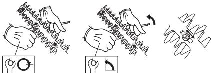
При правильной регулировке ножей, между ножами около болтов должен оставаться зазор в 0,2-0,4 мм.
