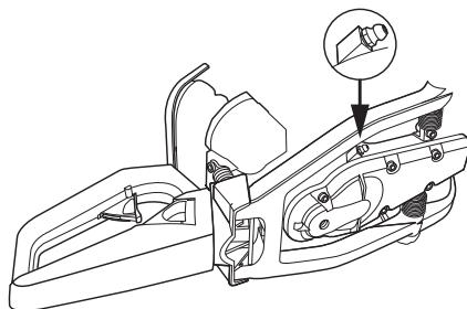
**ВНИМАНИЕ!** Обратите внимание на то, что передача не должна заполняться смазкой полностью. Солидол расширяется при нагревании в результате работы двигателя. Если коробка передач будет полностью заполнена солидолом, появится риск повреждения прокладок и утечки смазки.
