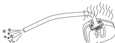
Если глушитель на вашей машине дополнительно оборудован искрогасящим фильтром, его следует регулярно прочищать.
