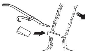
Мы рекомендуем пользоваться шиной пилы, длина которой бы превышала диаметр ствола, чтобы валивший и направляющий срезы могли выполнятся т.н. "одинарным срезом". См. указания в разделе Технические данные, относительно рекомендуемой длины шины пилы для Вашей модели моторной пилы.
