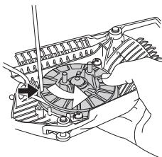
Снимите зажим в центре шкива. Снимите распорную втулку и шкив. Вставьте и натяните на шкиве новый шнур стартера. Намотайте примерно 3 оборота шнура на шкив. Соберите шкив стартера с возвратной пружиной так, чтобы пружина упиралась в шкив. Установите распорную втулку и закрепите шкив с помощью зажима. Пропустите шнур стартера через отверстие в корпусе и ручке стартера. Сделайте узел на шнуре стартера.
