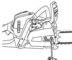
Цепь считается натянутой правильно, если она свободно проворачивается рукой. После этого, удерживая носок пильного полотна в вверхнем положении, затяните гайки крепления пильного полотна универсальным ключом.
