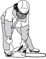
Так как тормоз цепи по-прежнему включен, двигатель должен как можно скорее быть переведен на холостые обороты, что может быть достигнуто за счет быстрого выключения ограничителя газа. Тем самым Вы избежите ненужного износа сцепления, барабана сцепления и тормозной ленты.
