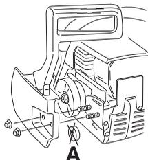
Установите пильное полотно на специально предназначенные болты. Установите полотно в самое заднее положение. Наденьте цепь на ведущую звездочку и вставьте ее хвостовики в паз пильного полотна. Начинайте с верхней стороны пильного полотна. Убедитесь, что кромки режущих звеньев направлены вперед на верхней стороне пильного полотна.
