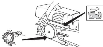
Установите штифт механизма натяжения цепи в специальное отверстие на пильном полотне и оденьте крышку сцепления. Проверьте правильность установки хвостовиков цепи на ведущую звездочку, протянув цепь вперед по
