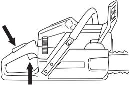
После того, как двигатель сделает первую вспышку, верните сразу рычаг воздушной заслонки в первоначальное положение, открывая воздушную заслонку, и повторите запуск. Когда двигатель запустится, дайте полный газ и отпустите рычаг дроссельной заслонки и блокировка пускового положения дроссельной заслонки отключится.
