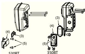
демонтаж сетки искроулавливателя:
