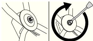
При необходимости руль можно слегка повернуть боком в сочленении руля управления. Руль можно устанавливать в различные положения, чтобы достигнуть наилучшего положения для работы, например, при скашивании травы рядом с изгородью или стеной здания.
