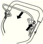
Тормоз двигателя необходимо настроить таким образом, чтобы двигатель останавливался в течение 3 секунд.
