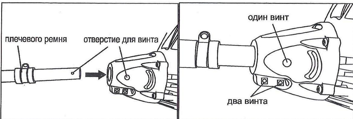
2. Утопите и поверните гибкий вал, до тех пор пока гибкий вал не войдет в сцепление. См рис:
