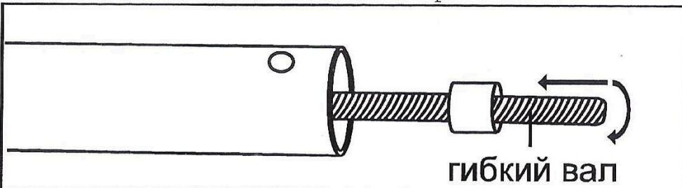
3. Вставьте редуктор в алюминиевую штангу и поворачивайте шпиндель до тех пор, пока отверстия для винтов на штанге и редукторе не совпадут. См рис:
