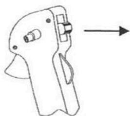
2. Залейте смесь в карбюратор медленным нажатием кнопки подкачки несколько раз до тех пор, пока бензин не поступит в карбюратор.
