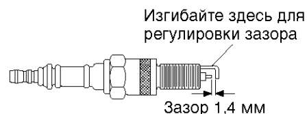
Рис. 12, Регулировка зазора свечи зажигания, нагреватель мощностью 10 кВт
