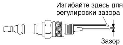
Рис, 15, Регулировка зазора свечи зажигания, нагреватели мощностью 20, 30 и 45 кВт
