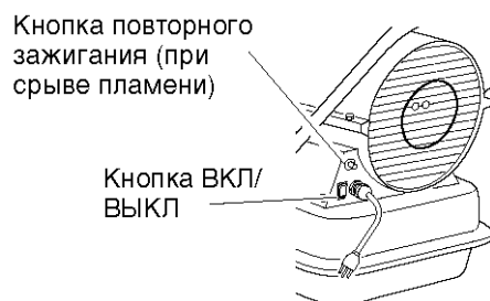
Рис, 5, Кнопка повторного зажигания для нагревателей мощностью 10 и 20 кВт
