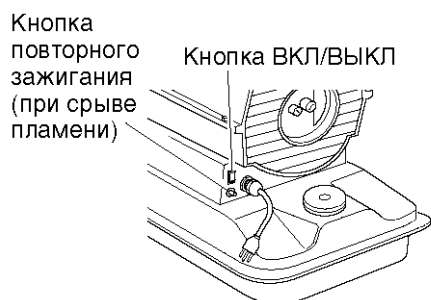
Рис, 5, Кнопка повторного зажигания для нагревателей мощностью 10 и 20 кВт
