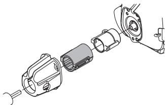
Регулярно проверяйте, чтобы на виброгасящих элементах не было трещин или деформаций.
