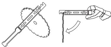
Проверьте режущее оборудование на наличие повреждений или трещин. Поврежденное режущее оборудование следует обязательно заменить.
