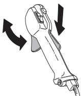
См. указания в разделе **Запуск**. Включите машину и полностью откройте дроссель. Отпустите рычаг дросселя и удостоверьтесь, что режущее оборудование останавливается и остается неподвижным. Если после постановки дросселя в положение холостого хода режущее оборудование продолжает вращаться, следует проверить регулировку холостого хода
