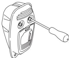
Если глушитель на вашей машине дополнительно оборудован искрогасящим фильтром, его следует регулярно прочищать.
