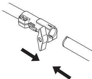
Перед использованием узла, хорошо затяните ручку.
