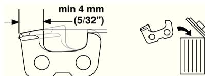
Общие сведения относительно снижения ограничителя глубины врезания.
