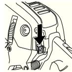
Остановка двигателя осуществляется нажатием на выключатель запуска/остановки.
