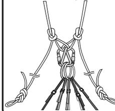
Рис. 6. Способы крепления на переправе
