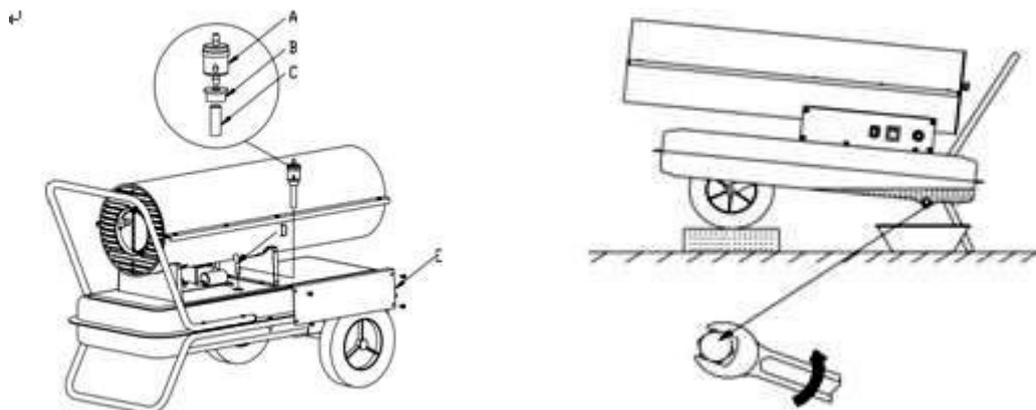
А - фильтр, В - заглушка, С - прозрачная трубка, D - вводная трубка, Е - боковая пластина
