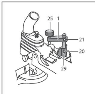
**ВНИМАНИЕ!** Всегда надежно закрепляйте заготовку струбциной. Отсутствие жесткой фиксации заготовки при пилении может стать причиной повреждения изделия и порчи заготовки, а также травм работника.
