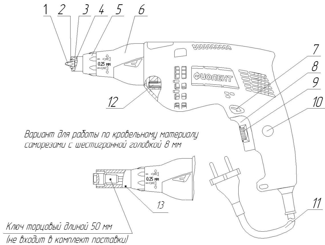
1 - отвертка вставка; 2 - магнит; 3 - втулка; 4 - шпиндель; 5 - регулировочная втулка; 6 - стакан; 7 - переключатель реверса; 8 - клавиша выключателя; 9 - диск; 10 - кнопка-фиксатор; 11 - шнур питания; 12 - механизм; 13 - втулка упорная.
