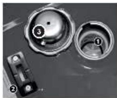
1 – сетчатый фильтр 2 – указатель уровня топлива в баке 3 – крышка топливного бака
