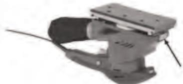
Выберите шлифовальную шкурку (4) в соответствии с обрабатываемым материалом. Используйте шлифовальную шкурку (4) с зернистостью 40 и соотв. 60 для грубой шлифовки и шлифовки на неровных поверхностях. Используйте зернистость 120 для более гладкого шлифования.
