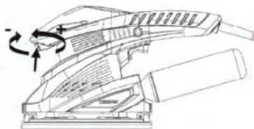
С помощью регулятора частоты вращения (9) вы можете отрегулировать частоту вращения в соответствии с областью применения. Выберите подходящую настройку частоты вращения и убедитесь, что шлифмашина не становится перегруженной и не останавливается.
